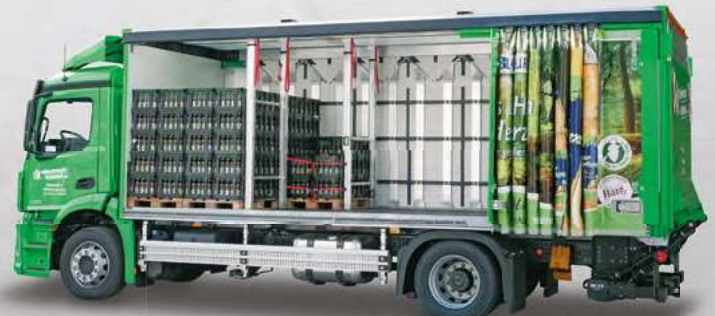
Schiebeplanenaufbau E-SP zertifiziert für alle Getränkegebinde
