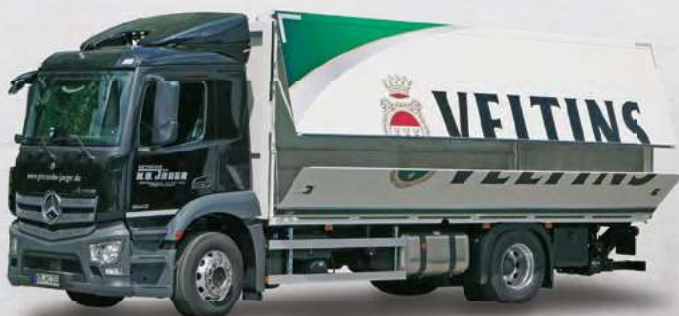
Schwenkwandaufbau PR-L für den Transport von Getränken in Kästen, Fässern und Rollwagen
