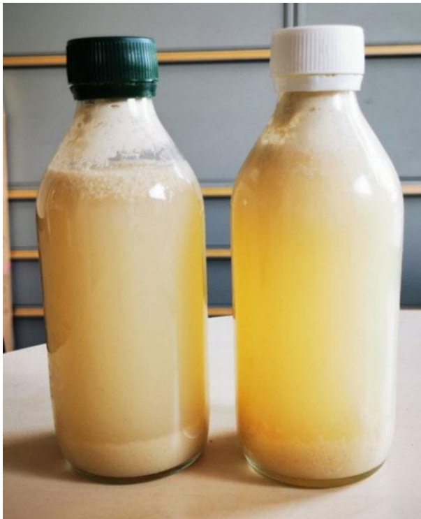
Abb. 3: Schlechtes Trübungs- und Absetzverhalten bei einer Läuterbottichfiltration
