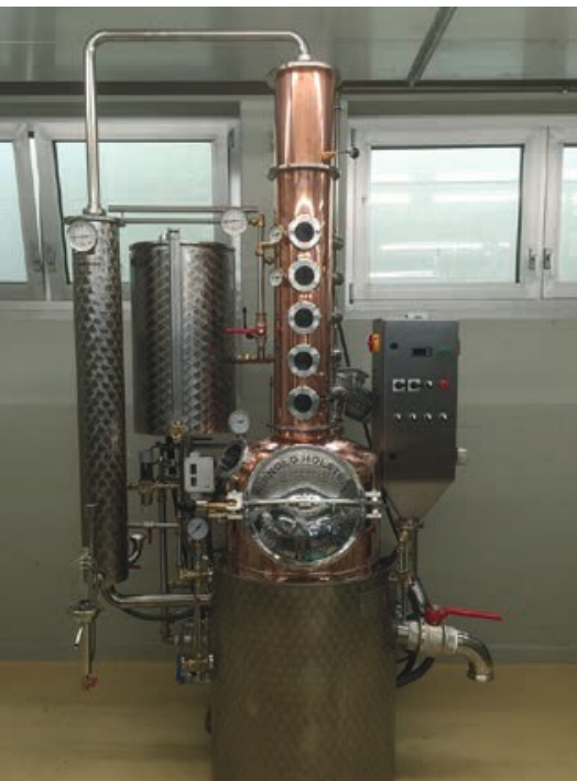
Die Destille mit einem Brennblausenvolumen von 80 Liter im Doemens-Technikum
